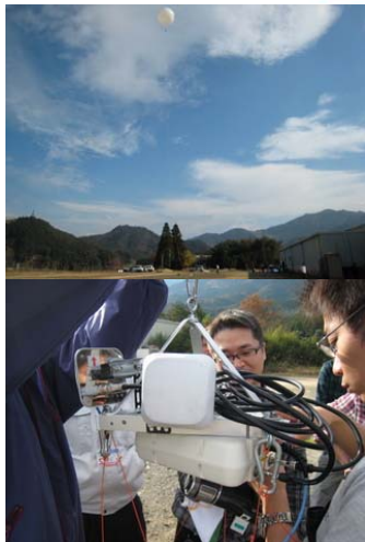
打ち上げられた無線LAN搭載バルーン
