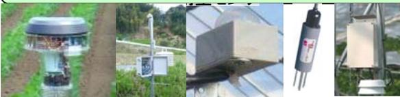
気温、湿度、水温、日射量、CO<sub>2</sub>、土壤水分、ECなどの環境情報を連続計測する技術を開発(改良)。
