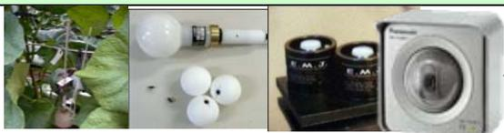
繁茂度光計測センサー、果重センサーによるメロンの繁茂度や果重、ICタグリーダーやカメラ画像による水稲苗草丈、などの生体情報の連続計測技術を開発中。
