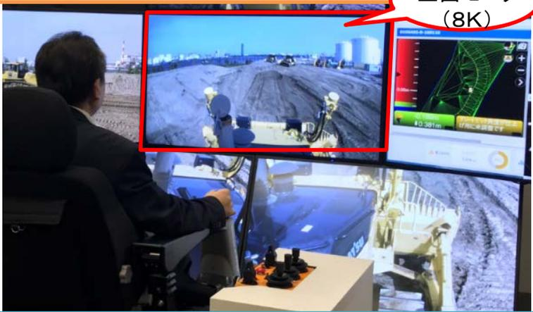
東京港区から千葉市美浜区の建機を低遅延で遠隔操作 ⇒ 農耕機（トラクタ等）などへの応用が可能
